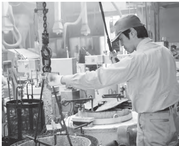
焼戻しは温度と時間の管理が重要で、気を抜くことができない。
