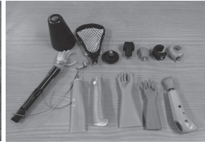
▲リハビリテーション室には患者さんたちの作品を陳列している。作業療法士が作成したプログラムに基づいて、陶芸や工芸などのものづくりを通して機能の回復を目指す。(左)作業療法士は、患者さんの特性に応じて自助具をつくることもある。その際に使われるのが、熱を加えるとやわらかくなり、冷えると固まるスプリント材と呼ばれる素材。(中)左端は筋電義手で、筋に伝わる微弱な電流を感知して動く。上のパーツ類は作業用義手で、用途に応じて使い分ける。下は外観を重視した装飾用義手。(右)
