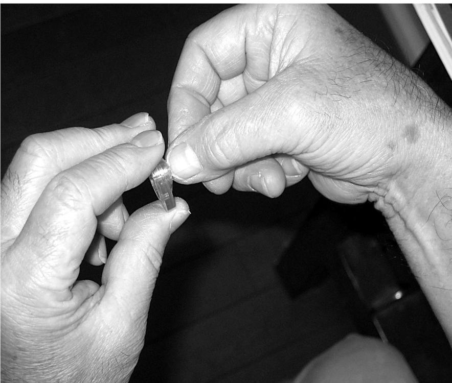
ポケットに入っていた5円玉の穴に指が当たったことから発想したという「うす削り」。上部にある穴の内側にはやすりがつけられている。穴に爪先を当て、うす削りを軽く移動すると爪を削ることができる。刃は鈍角になっているために皮膚を傷めにくい。刃が磨耗して削れなくなったら、逆さにしてサンドペーパーで磨けば半永久的に使える。
