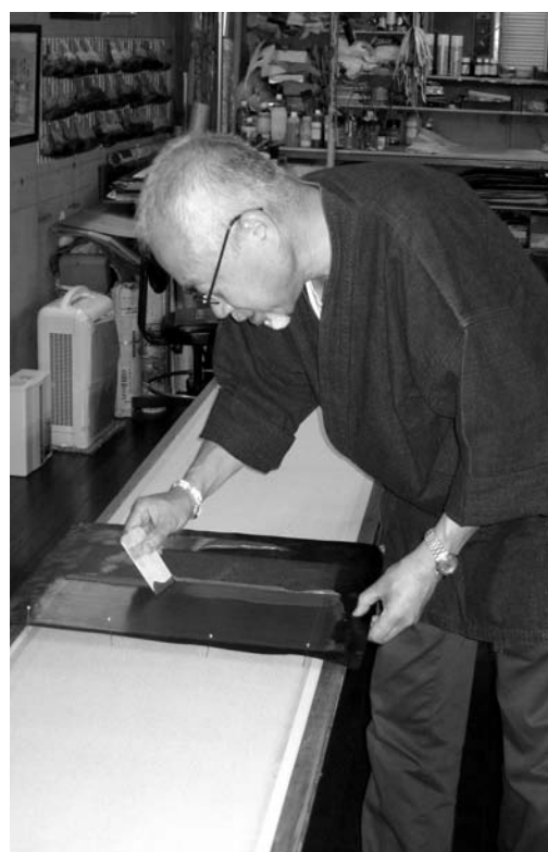
細心の注意を払いながら型付けを行う。長板の上に貼った生地に型紙を載せ、その上からへらで防染糊を置いていく。
