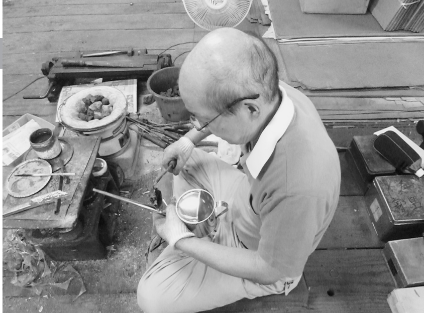
部品をはんだ付けしている様子。根岸さんは如雨露作りの全工程を一人で行う。
