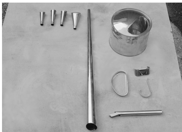
如雨露はさまざまな部品から構成される。円錐形の部品は口金で、水やりの用途に応じて数種類を使い分ける。根岸さんの作る如雨露は長い竿が特色。試行錯誤の結果、このような形になった。この長い竿で水圧を調整し、盆栽にやさしい水を注ぐことができる。
