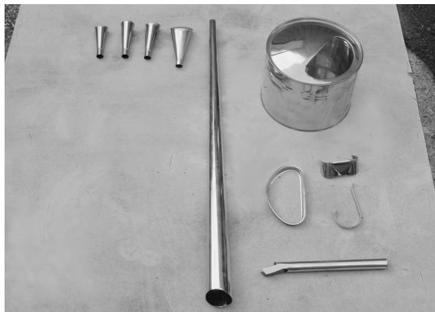
如雨露はさまざまな部品から構成される。円錐形の部品は口金で、水やりの用途に応じて数種類を使い分ける。根岸さんの作る如雨露は長い竿が特色。試行錯誤の結果、このような形になった。この長い竿で水圧を調整し、盆栽にやさしい水を注ぐことができる。
