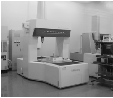
目盛りの部分にガラススケールが使われる 三次元測定機
