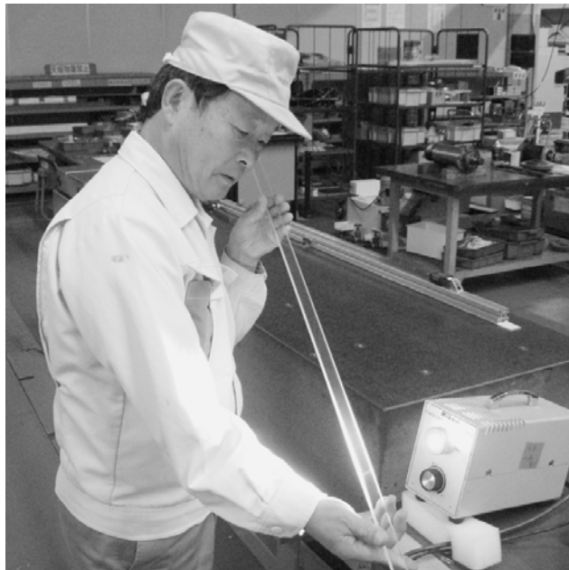
研削したガラススケールの微妙なたわみをチェックする
