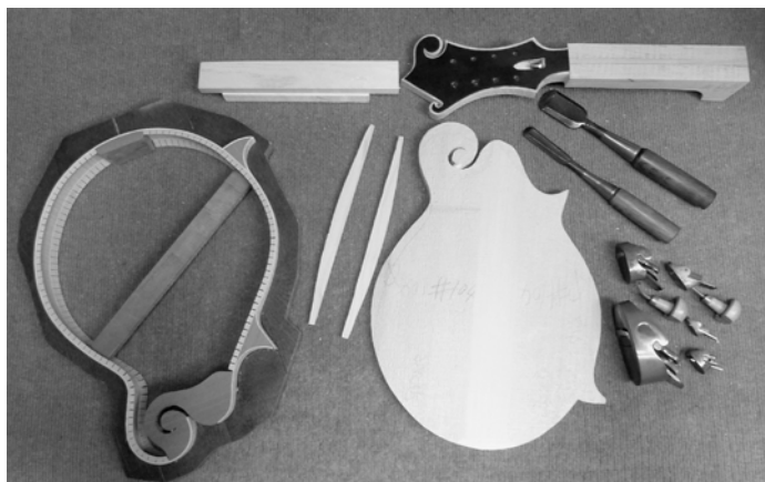
マンドリン製作に使われる各パーツと道具類。右下の道具は専用の鉋で特殊な形をしている。
