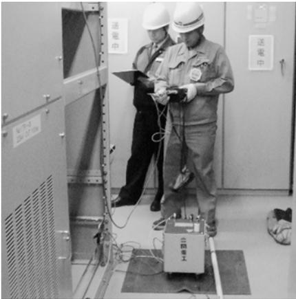
特別高圧受変電設備使用前自主検査(耐圧試験):施設の使用開始前に受変電設備が性能通りであるかどうかを高い電圧をかけて確認する。(上下とも)
