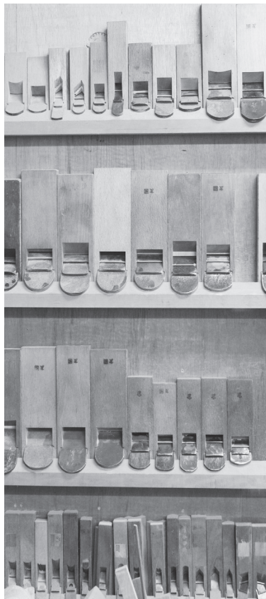
▲建具を作るときには、何種類もの道具を使う。鉋だけでも多くの種類がある。
