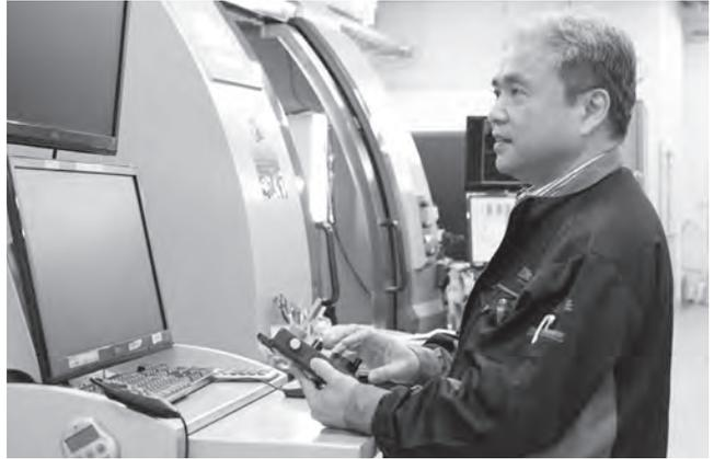
例えばレーザーディスク、現在ではブルーレイディスクですが、普通に表面に傷が付くと音声なり映像が飛びますよね。それを実証するのです。つまり、どのくらいの長さでどのくらいの深さの傷が付くと製品に影響を与えるのか、表面にミクロンの傷をつけるようになるのか、製品として大丈夫なのかということを検証しているのです。
