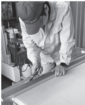
畳表の表面は山・谷・山・谷と織り込まれており、畳縁を縫い付けた際に谷がちょうど見えなくなるように目押し定規を使って畳表の切り位置を確認し（写真右）、畳表の上前（うわまえ：畳同士がつながるほう）を畳の大きさに合わせて長い6尺定規でまっすぐ切り落とす（写真左）。
